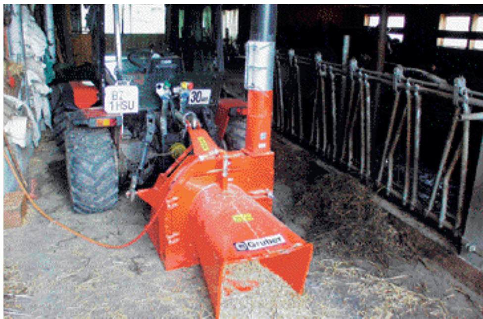
Die Strohmühle ist auf einen 70 PS starken Motormähwender am Dreipunkt aufgesattelt. Der Antrieb der Mühle läuft über die Zapfwelle. Fotos: Gerhold
