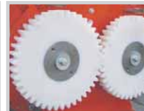
Der starke Polyamid-Doppelzahnradantrieb garantiert beste Quetschqualität bei geringem Staubanteil, ohne Geräusentwicklung
