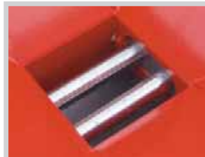
Starke Magnete trennen Eisenteile vom Getreide
