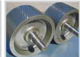
Garanten für ein optimales Quetschgut mit geringen Staubanteilen sind Quetschwalzen mit einem großen Durchmesser von 300 mm.
