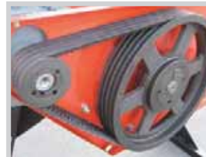
Großdimensionierter Schmalkeilriemenantrieb sorgt für sicheren und lautlosen Betrieb
