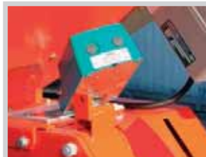
Bei automatischen Anlagen, bei denen die Quetsche selbstständig starten und stoppen muss, ist ein elektrischer Einlaufschieber notwendig
